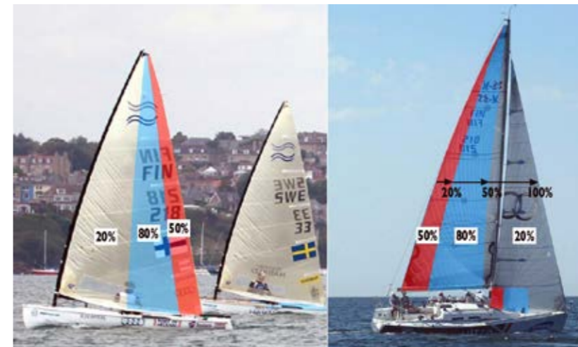
Takaliesman sulkeminen: taaimmainen 20 % purjepinnasta hallitsee 50 %:ia voimasta (punainen alue), taaimmainen 50 % hallitsee yli 80 %:ia (sininen). Sen vuoksi purjeiden trimmauksessa päähuomio kiinnittyy purjeen takaliesmaan ja sen kulmaan tuuleen nähden: mitä jyrkemmässä kulmassa takaliesma kohtaa tuulen, sitä enemmän voimaa purjeesta saadaan.
